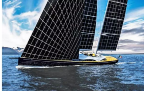
▲Helios 太阳能“帆船”:Helios 也是一款概念产品,它豪华游艇的内心里,却裹着一个奇怪的帆船造型,不过普通的帆在这里换成了太阳能电池板。据悉,该船的“帆”将由 2500 块太阳能电池板打造而成,可以产出 355kWh 的清洁能源。此外,这艘大游艇可真够长,达到了 180.5 英尺(约合 55 米),其船上的配置也是奢华至极,设计师甚至为它安了个电影院。
