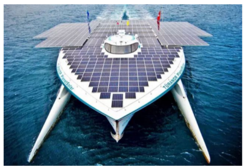
▲PlanetSolar 公司的图拉诺号:图拉诺号可是世界纪录的保持者,它在 2012 年成功完成了为期 18 个月的环球航行,该船也顺利荣登世界最大太阳能船的宝座。这艘造价 2600 万美元的双体太阳能船长 101 英尺(约合 30.7 米),宽 49 英尺(约合 15 米),最多可搭乘 50 名乘客。而驱动它航行的则是船身上覆盖的 537 平米的太阳能电池板。
