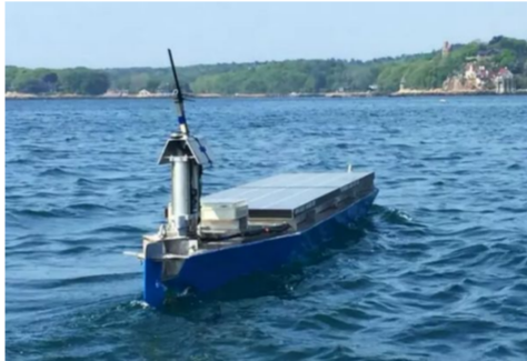
▲能自动驾驶的 SolarVoyager:虽然大多数太阳能驱动的船只是大家伙,但也有例外。SolarVoyager 就是其中之一,这艘低矮的小船上架设了一整个太阳能屋顶。眼下,这艘船正繁忙的穿梭于大西洋上。此外,值得一提的是,这艘船航行时无需搭载船员,负责远程操控的人员还能通过卫星对其进行实时升级。
