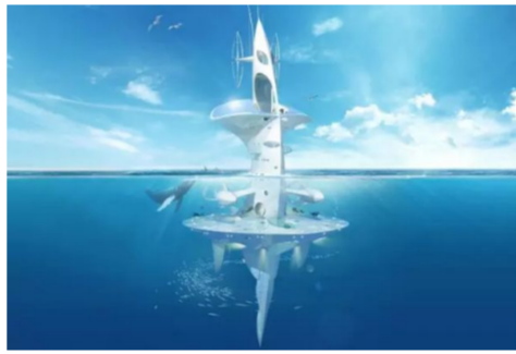
▲SeaOrbiter 号海洋研究船:由法国建筑师一手打造的,这艘太阳能船有很大一部分位于水下,这样就能满足其对海洋长期研究和观察的要求。该船的水下结构设计非常精妙,它甚至为潜水员留了休息的平台。不过,虽然在两年时间内招募到了 38.8 万美元,但这艘船暂时还停留在设计图状态。
