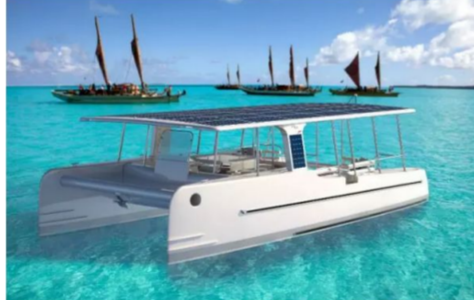
▲SoelCat12 游艇:这艘游艇虽然没有 Solaris 那么豪华,但也概念性十足。Soel-Cat12 由荷兰设计师设计,全长 39 英尺(约合 12 米),采用轻型柔韧材料打造。该船共搭载 809 块太阳能电池板,在普通航行模式下,它能悠闲安静的行驶在海上,如果要激烈驾驶,还能打开船上搭载的两台强力电动机。
