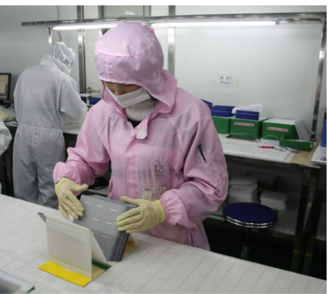
因为 QA 使用自制检片夹具检查电池片外观。周莉摄
